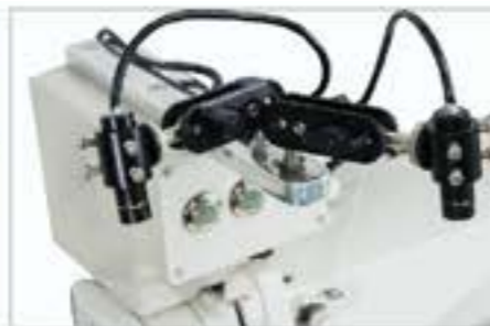
红外线定位装置 Infrared positioning device
