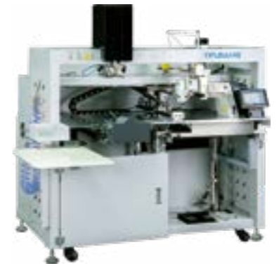
JCL1R 全自动衬衫右袖叉工作站 Automatic right shirt sleeve placket attaching machine
